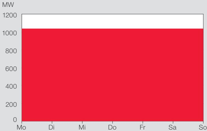
Abbildung 5.14: Kernkraftwerke werden in der Schweiz auf Auslegeleistung gefahren. Die Abbildung zeigt den Volllastbetrieb des Kernkraftwerks Gösgen in einer Sommerwoche (Maximalleistung 1035 MW).
