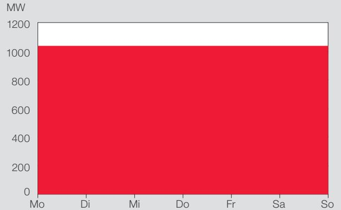
Abbildung 5.15: Kernkraftwerke werden in der Schweiz auf Auslegeleistung gefahren. Die Abbildung zeigt den Volllastbetrieb des Kernkraftwerks Gösgen in einer Winterwoche (Maximalleistung 1035 MW).
