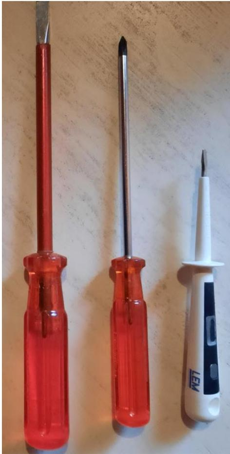
Schraubenzieher isoliert und Spannungsfest
