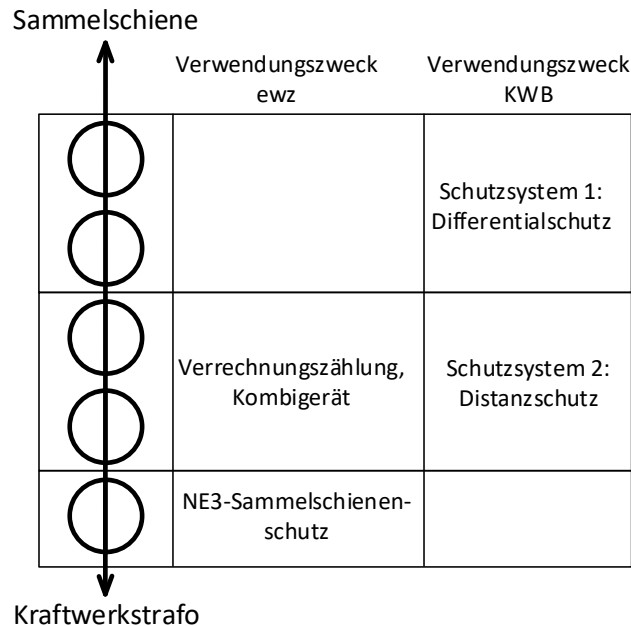
Abbildung 12: Möglichkeit für Stromwandlerbeschaltung
