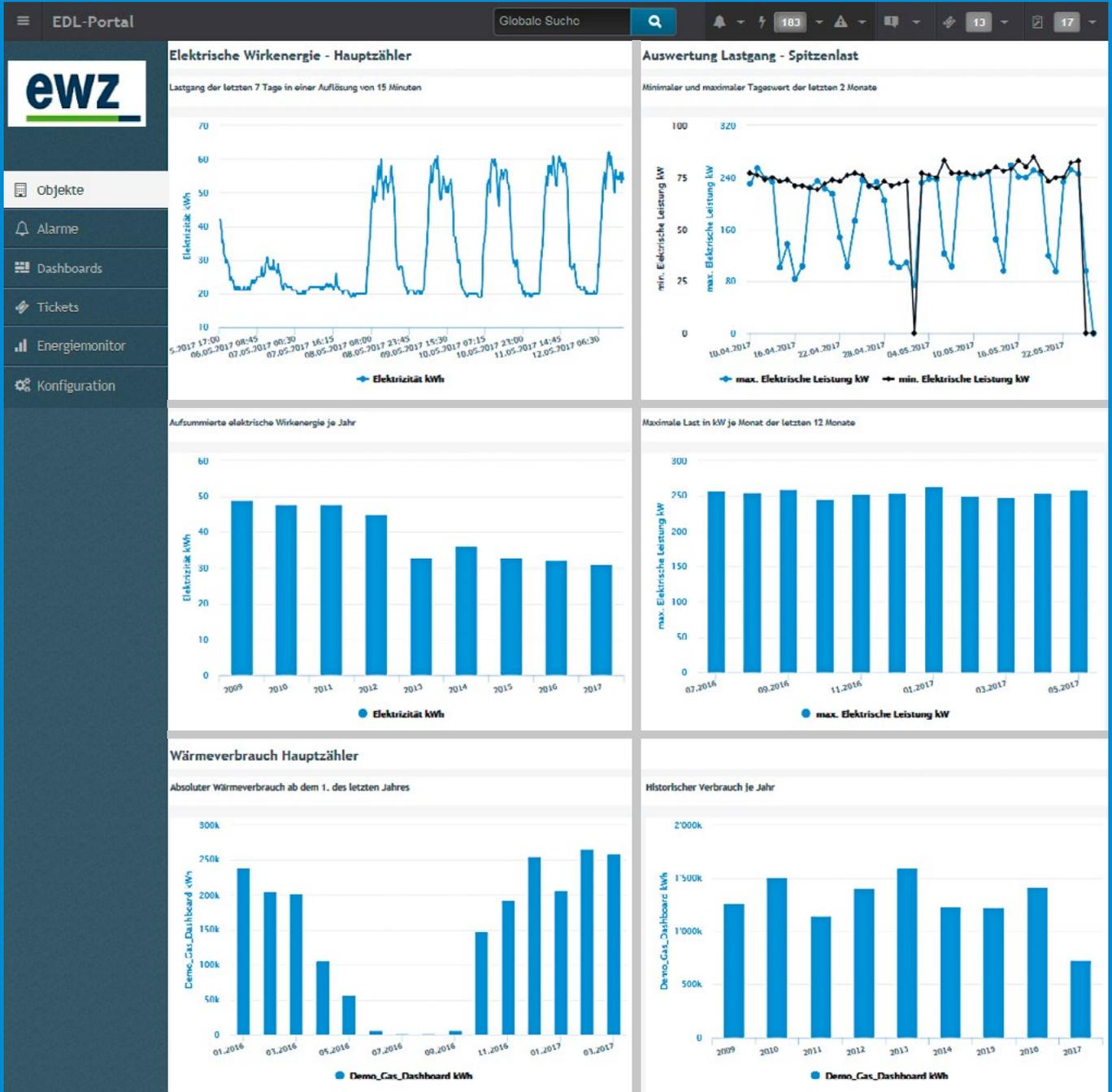
Die Basisversion von ewz.energiemonitor zeigt auf dem Dashboard die von Ihnen ausgewählten sechs Widgets. Zusätzlich erhalten Sie Auswertungen des Stromlastgangs, das Heatmap sowie die integrierten Wetterdaten.
