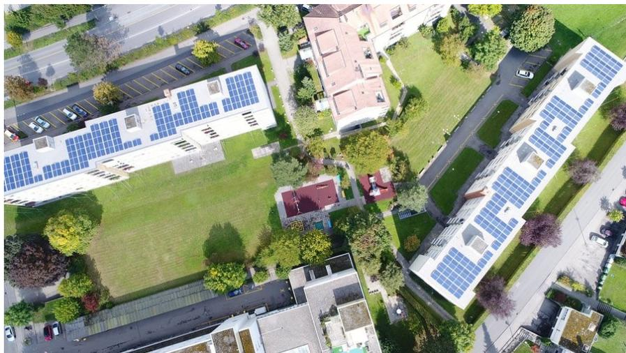
Auf zwei Dächern einer Wohngenossenschaft hat ESB Energie Service Biel/Bienne zwei Photovoltaik-Anlagen realisiert, die zusammen rund 107 MWh Strom pro Jahr produzieren. Der Sonnenstrom soll den Allgemeinstrom (Heizungspumpen, Aufzug, Waschmaschinen, etc.) der Gebäude decken. Angestrebt wird ein Eigenverbrauchsanteil von nahezu 70 %.
