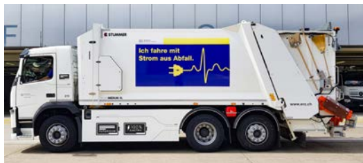
Die Flotte der Abfallsammelfahrzeuge von ERZ wird laufend auf elektrische Antriebe umgerüstet. (Bild: ERZ)
