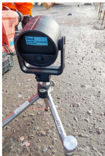
Ein abgesteckter Punkt, der für die Fenster und Fassaden gebraucht wird. (Bild: GeoZ)
