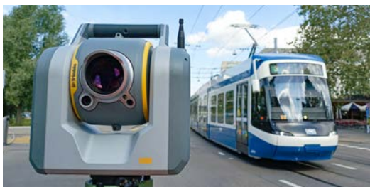
Der neue Standard bei GeoZ, eine Totalstation vom Typ Trimble SX12 im Einsatz an der Kreuzung Usterstrasse/Gessnerallee. (Bild: GeoZ)
