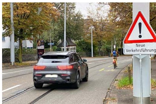
In einem Verkehrsversuch auf der Hofwiesenstrasse teilen sich Autos und das Tram zugunsten eines Velostreifens die Fahrbahn. (Bild: TAZ)
