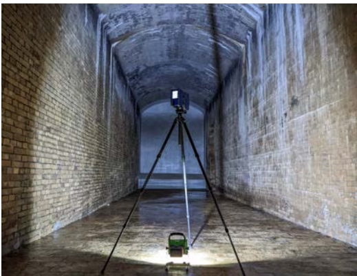
Laserscanner FARO in den Kammern des Reservoirs Rämi (Bild: GeoZ)
