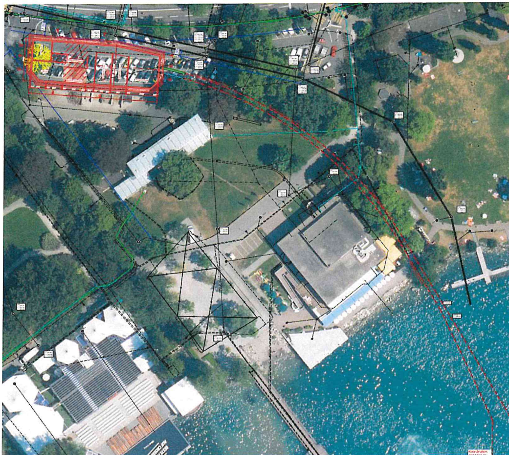
Abb. 3 Unterirdische Energiezentrale und Seewasserleitungen (rot markiert).
