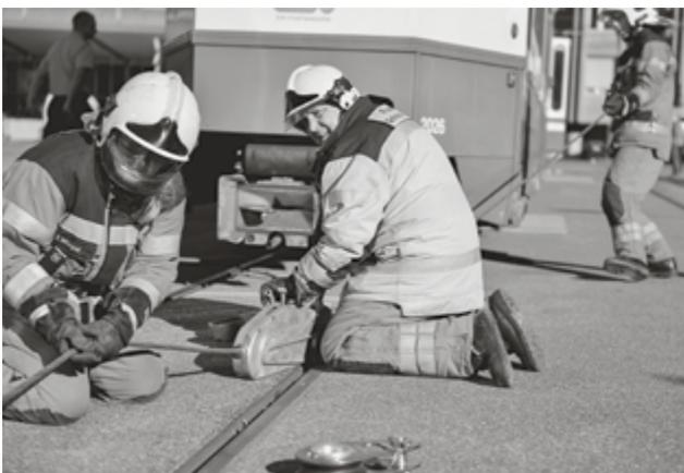
Angehörige der Milizfeuerwehr üben das Abschleppen eines Tramwagens mit dem Seilzugapparat. (Bild: Schutz & Rettung)
