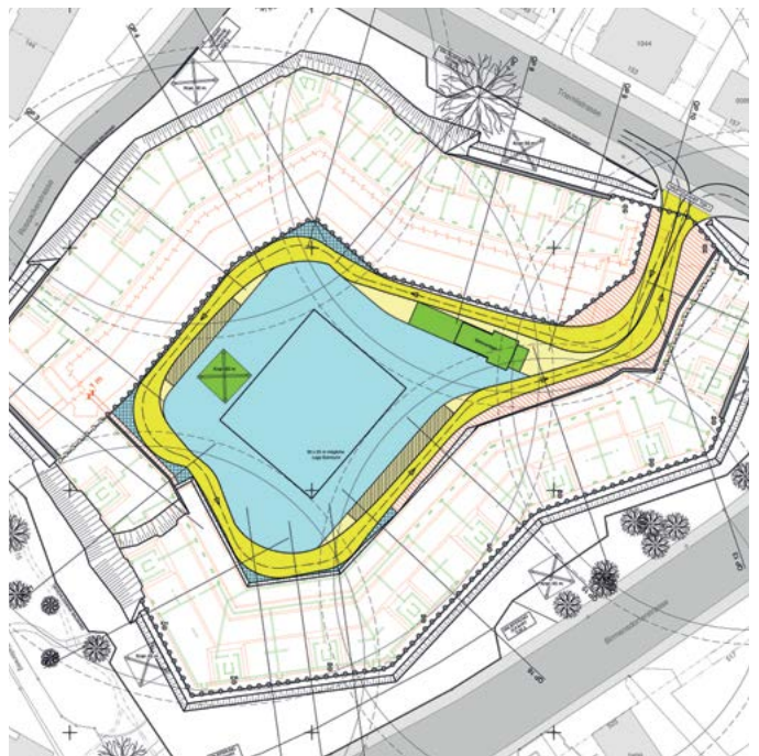
Abbildung 8: Baustellenübersicht der Liegenschaft Triemli der BG Sonnengarten. blau: Bohrplatz, gelb: Rundkurs, grün: Baukran und Betonmischanlage der Bauunternehmung.
